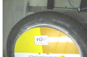
Bild 3: Verformungen nach Impact-Test
